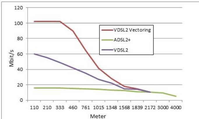
Die max. Bandbreite hängt von der Entfernung zwischen ARU und Haushalt ab.
